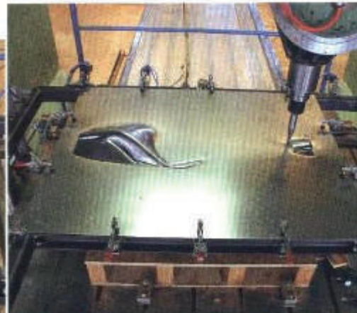
Anhand des eingescannten Musters wird eine Holzform gefräst. CNC-gesteuerter Umformkopf in Aktion (Mitte). Firmengründer Till Pfeifer und Jens Christian Desol mit Arbeitsprobe
