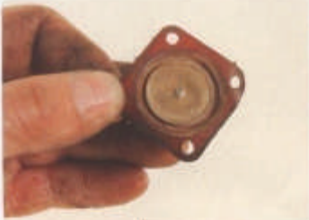
Die absolute Härte: Ältere Membranen können im Zeitraffertempo verspröden – und dies auch während des Fahrbetriebs
