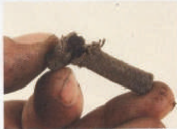
Ruinös: Benzinschläuche sollten regelmäßig kontrolliert werden. Gewebeummantelte Schläuche sind für heutige Kraftstoffe nicht...
