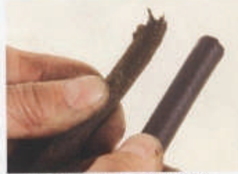
...mehr geeignet. Besser auf dreilagige Gummischläuche (z.) umsteigen. Doch selbst sie können von Diesel angegriffen werden!
