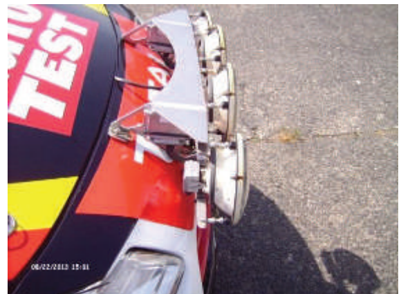
So sieht heute gutes Fernlicht aus: LED-Leuchten satt (rechts Xenon). Die Nacht wird zum Tag bei weniger Leistungsaufnahme.
