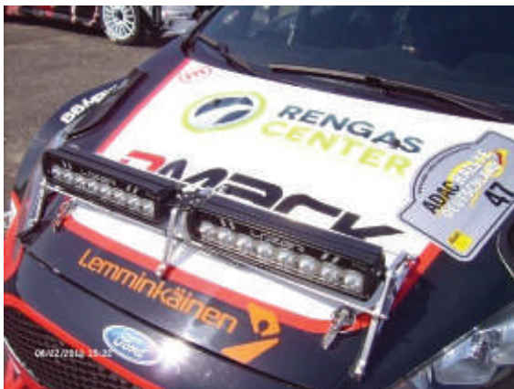
So sieht heute gutes Fernlicht aus: LED-Leuchten satt (rechts Xenon). Die Nacht wird zum Tag bei weniger Leistungsaufnahme.
