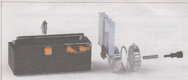
Elektrobaukasten: Batterie, Inverter, Elektromotoren mit Ausgangswelle
